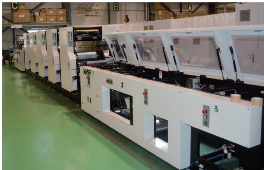
新開発の軟包装向け間欠式LED-UVオフセット印刷機「VAR18B」の展示機。 現在は四国化工に設置されている
