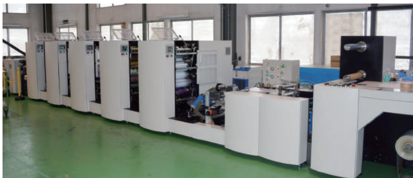
スリーブ式LED-UVオフセット印刷機「MHL13A」。連続印刷により生産性が高く、見当精度にも優れる一方、ジョブ交換が頻回な場合は作業性が課題となる
