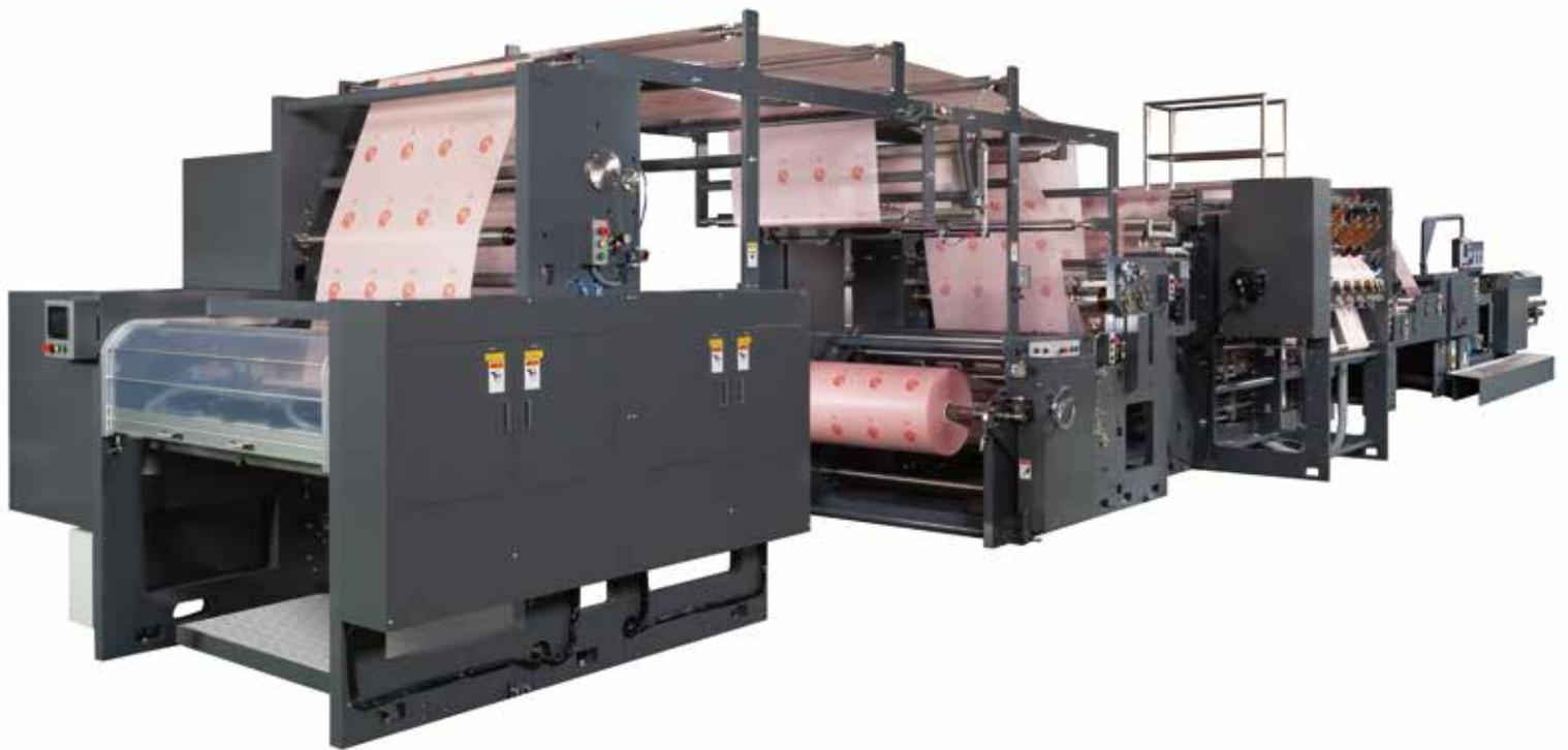
包装紙向け水性フレキソ印刷+インラインシートカット装置
