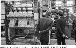
トカット装置「MF X52S」 包装紙向け水性フレキソ印刷+インラインシ
