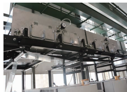
プライマーコーティングユニット (左) と乾燥炉。UVプライマーの場合、基材はLED-UV硬化装置を経て印刷ユニットに向かう
