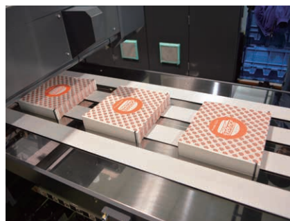
1列に重ねてカットし(左)、最終的に所定の枚数に区分けされる(100~2000枚)。なお、途中の検査工程で欠陥が発見されたものはリジェクト装置によって除外される
