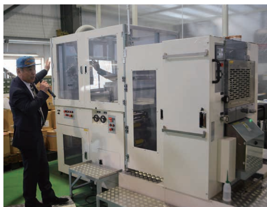
VPP13WLの巻出ユニット。紙継ぎ装置やコロナ処理装置が組み込まれている
