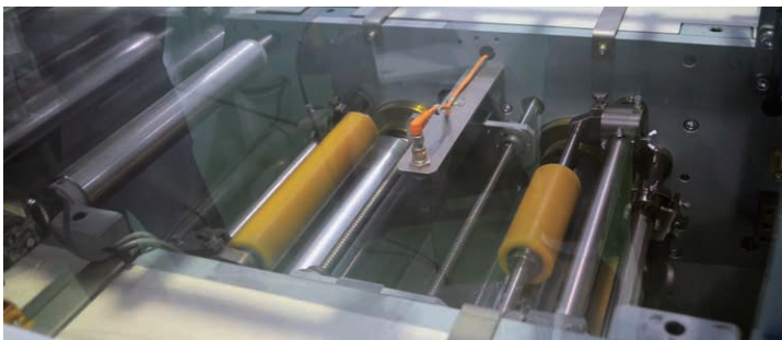
印刷ユニット全体の前に設置されたループ制御機構（左）と後ろの同制御機構。黄色のローラで基材をグリップして正確なステップバック動作を行っている。ローラ表面にはグリップ力を高める表面処理がなされている
