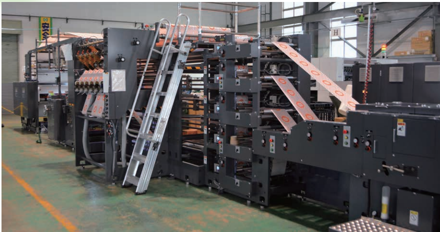
スタック型水性フレキソ印刷部とインラインシートカット装置を組み合わせたMFX52S
