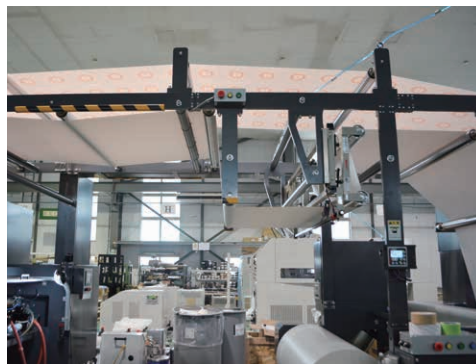
上部で印刷後の基材が搬送されているが、ここに乾燥炉を設置することも可能
