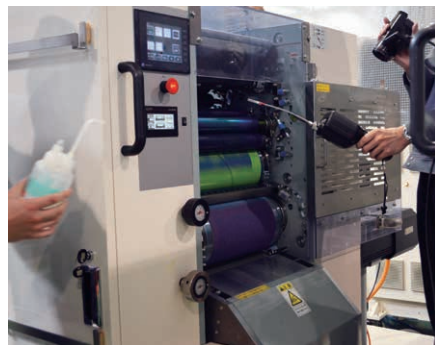
版胴を水系洗浄剤で洗浄し、VOCの発生量を調べたところ、センサーの数値はゼロを示した
