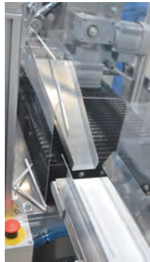
カッティングユニット（カバーを上げた状態）。5つのカッティングナイフの位置でストローの長さを調整できる。右写真はカット後の紙ストローの排出部
