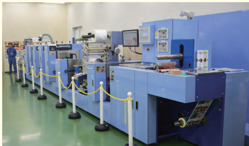
コンパクトな間欠オフセットラベル印刷機「MLP 10L」(左)とカセットタイプのLED-UV IJ印刷ユニット(ヘッドを引き出したところ)
