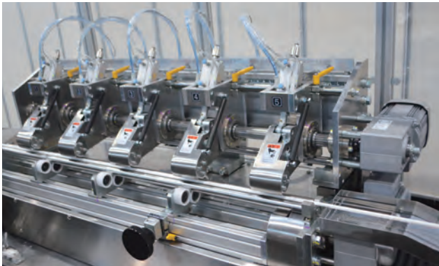
カッティングユニット（カバーを上げた状態）。5つのカッティングナイフの位置でストローの長さを調整できる。右写真はカット後の紙ストローの排出部
