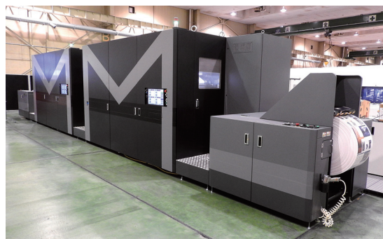
写真 7 ラベル用 LED-UV インクジェット印刷機 MJP13LXV
