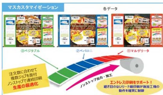
図2 小ロット+多品種+同型のジョブを元巻一本に面付
